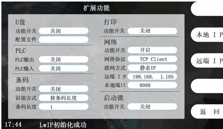
图 2.13 网络参数设置&远端 IP
