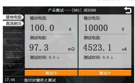
如上图所示, 直流耐压 与接地电阻可以同步并行测试, 速度倍增。
