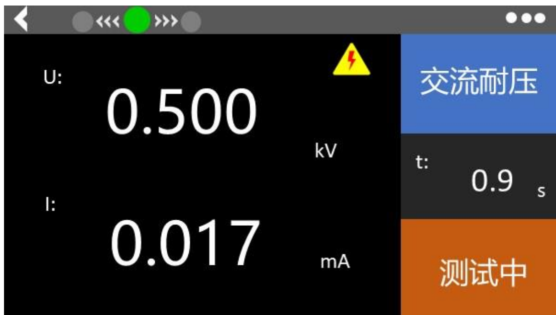
图 5-6-1 测试执行过程中示意图
