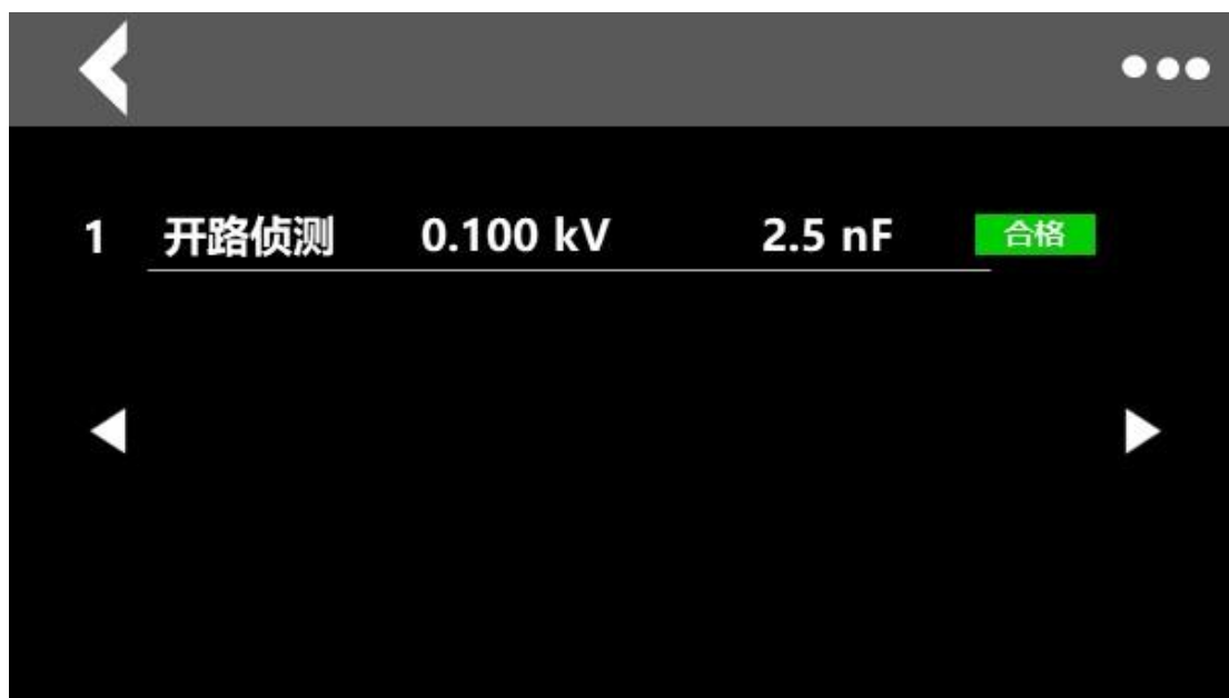
图 5-5-5 开路侦测测试结果界面
