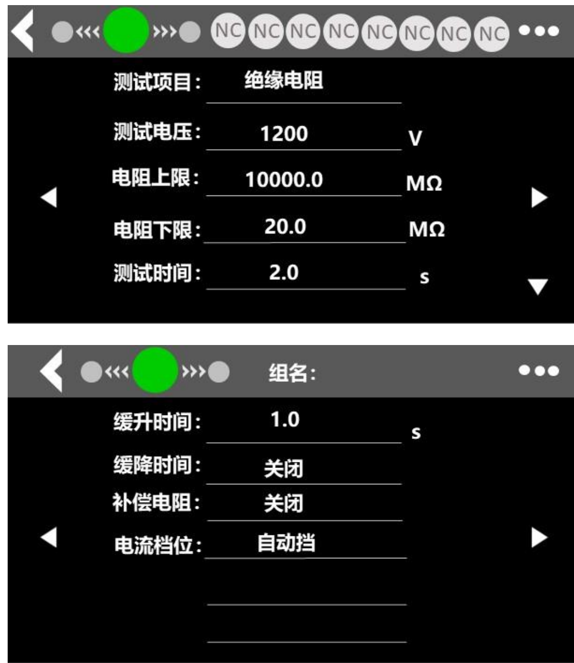
图 5-5-4 绝缘电阻设置界面
