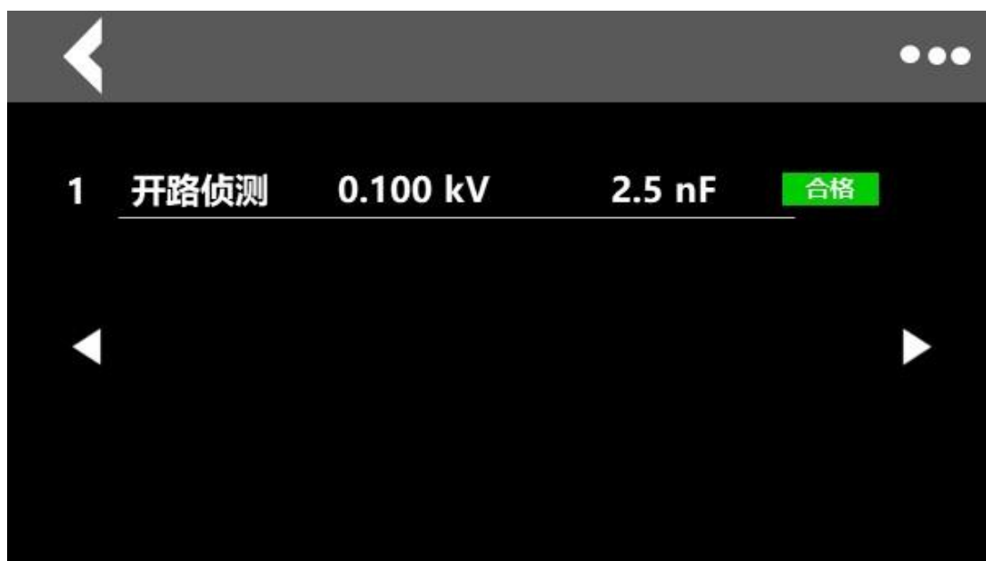
图 5-5-7 开路侦测测试结果界面
