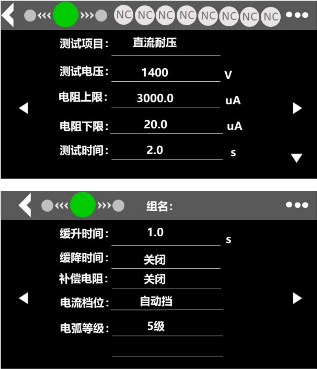
图 5-5-3 直流耐压设置界面
