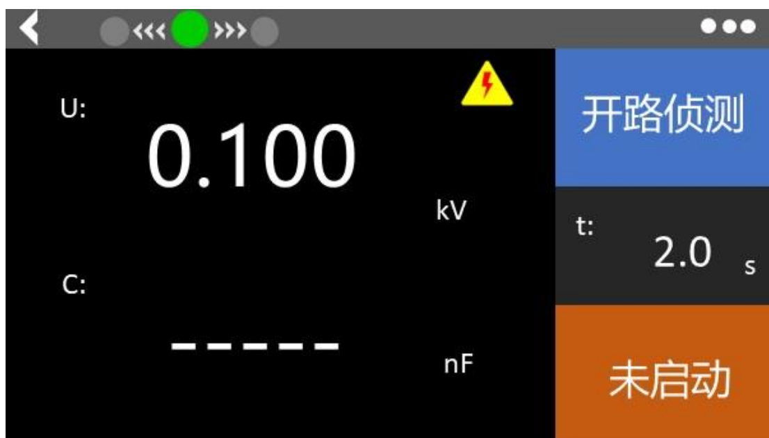
图 5-5-6 开路侦测测试界面
