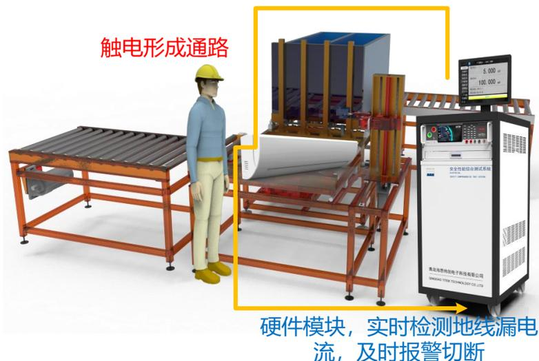
图 3-1-1 漏电快速断电保护原理
