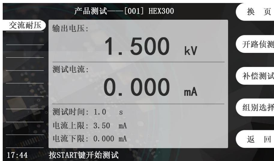
图 5-6-1 产品测试待测界面
