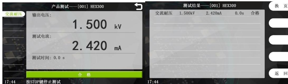
图 5-3-4 测试完成后显示单步结果
