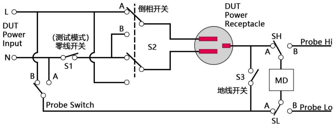
3、Probe-HI To Line (PH-L): SH 开关位于 B 位置, SL 开关及 Probe Switch 位于 A 位置
