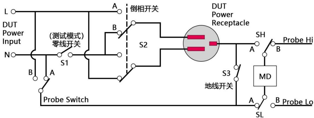
被测物状态：单一故障、L/N 反向（对 L 线 Single Fault to Line）
