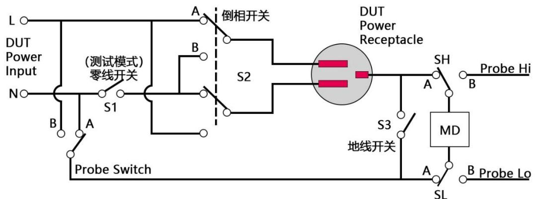
被测物状态: 单一故障 (对 N 线 Single Fault to Neutral)
