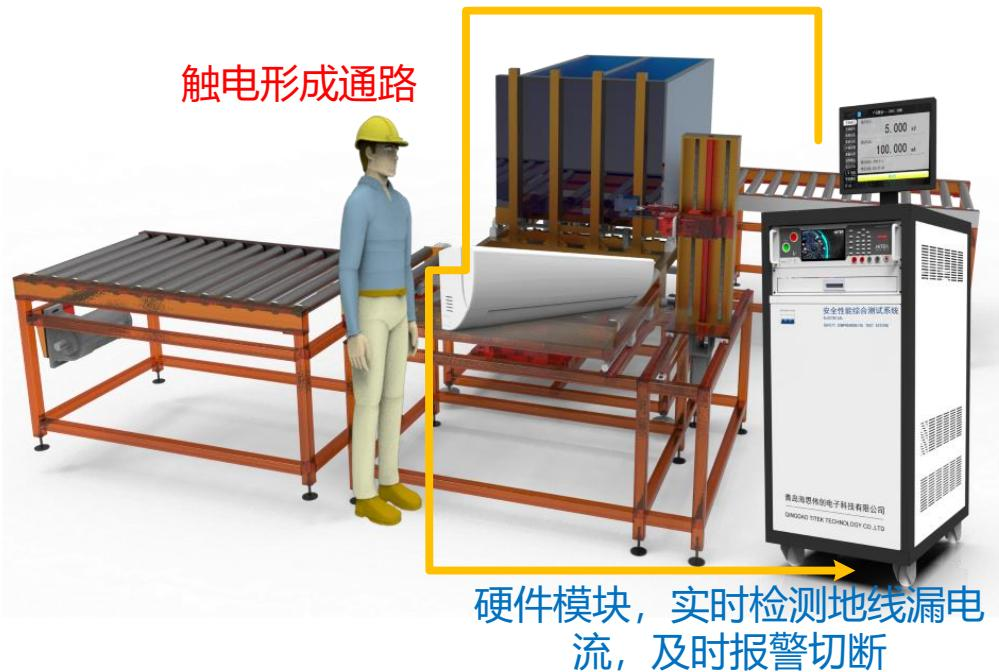
图 3-1-3 漏电快速断电保护原理
