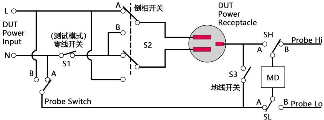
4、Probe-HI To Probe-LO (PH-PL): SH、SL 开关位于 B 位置, Probe Switch 位于 A 位置
