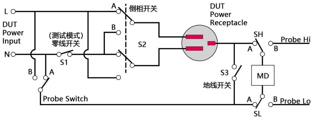
2、零线对地 Ground To Neutral (G-N): SH、SL 开关位于 A 位置, Probe Switch 位于 B 位置
