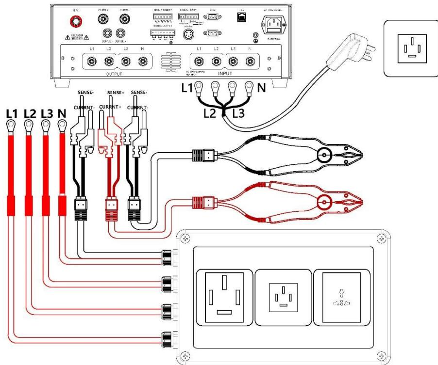
图 5-1-2HEX430 连接测试盒和接地测试钳示意图
