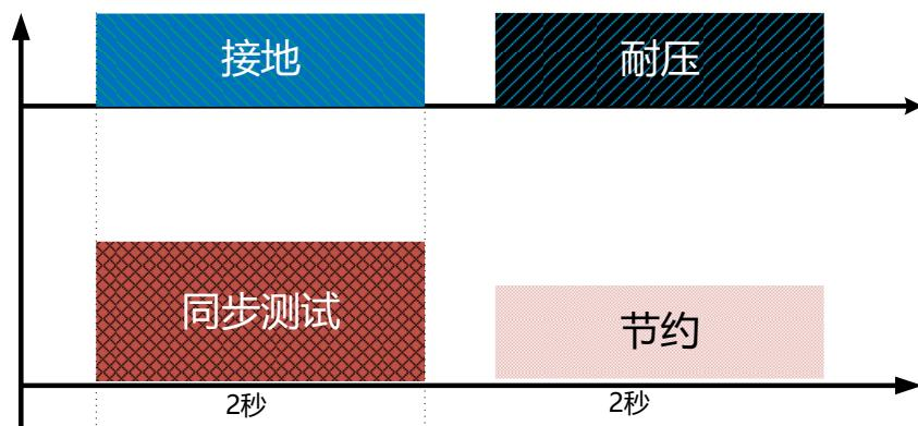
图 3-1-1 并行测试与普通测试的时间关系
