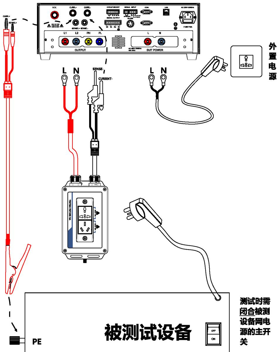
图 5-1-1 HEX410/HEX420 连接测试盒和接地测试钳示意图
