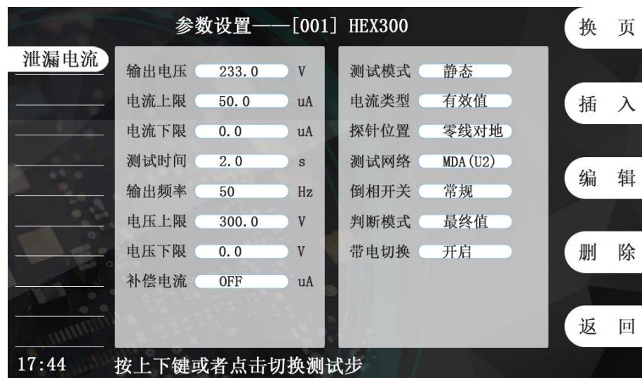
图 5-5-7 泄漏电流设置界面
