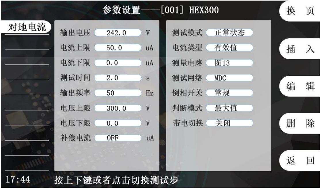
图 5-5-8 医疗泄漏电流设置界面
